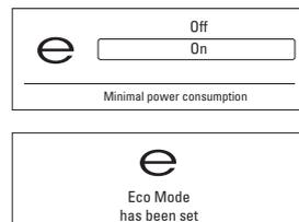
**LORSQUE ECO EST ACTIVÉ,** l'affichage s'éteint automatiquement au bout d'un moment pour économiser l'énergie. Il se rallume automatiquement lors de la sélection d'une touche ou de l'ouverture de la porte.
