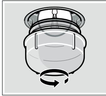
3. Remplacer l'ampoule par un modèle identique.
