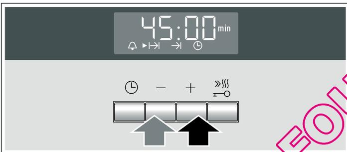
Le four se met en marche quelques secondes plus tard. Dans l'affichage, la durée s'écoule visiblement et le symbole
