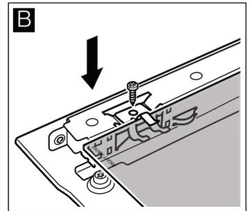
3. Engager la vitre du dessus vers l'arrière en l'inclinant. La face lisse doit être à l'extérieur.
