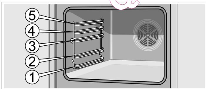
L'accessoire doit être retiré jusqu'à environ la moitié pour qu'il s'encliquette. Il est ainsi plus facile de retirer les plats.
