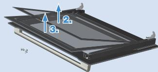
**03** | Soulevez la vitre n°2 et retirez les deux supports à ressort du haut de la vitre, puis retirez la vitre n°3. Nettoyez les vitres avec de l'eau chaude additionnée de liquide vaisselle et essuyez-les à l'aide d'un chiffon doux et propre.
