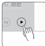
**2** Tournez le bouton multifonction pour sélectionner un niveau (Low (faible), Medium (moyen) ou High (élevé)) en fonction du degré de saleté du four. Appuyez sur le bouton Suivant pour démarrer la pyrolyse.
