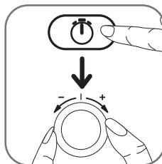
Drücken Sie die Taste **OK**. Sagen Sie die Zubereitungsdauer ein, indem Sie den Auswahlschalter drehen, bis die gewünschte Zeit angezeigt wird. Die Digitalanzeige gibt die Zeit in Stunden/Minuten an (Bsp.: 0:45). Drücken Sie die Taste **START**, falls die Zubereitung sofort beginnen soll.
