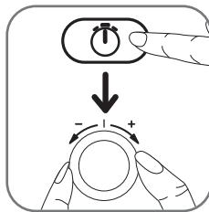
Appuyez sur la touche **()**. Réglez la durée de cuisson en tournant le sélecteur jusqu'à obtention du temps désiré. L'afficheur digital vous indique le temps : heures/minutes (ex. : 0:45).
