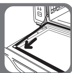
Replacez la vitre intérieure (marquages côté intérieur de la porte). Attention à bien positionner la vitre : les coins **arrondis doivent être en bas** (vers l'articulation de la porte). Engagez les coins supérieurs en 1<sup>er</sup> dans les encoches (voir les flèches).
