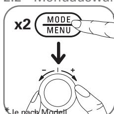
Drücken Sie 2 Mal hintereinander die Taste , um vom manuellen Betrieb in den Modus der automatischen Menüs zu wechseln. Die Digitalanzeige zeigt MENU und eine blinkende 01 an. Wählen Sie das gewünschte Menü mithilfe des Drehknopfs (1e) aus.
