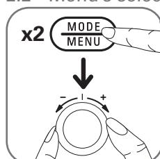
Druk 2 keer achter elkaar op de toets om van de handmatige functie over te gaan naar de automatische functie. Het digitale display geeft MENU aan en 01 knippert. Kies het gewenste menu m.b.v. de draaiknop (1e).
