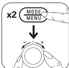
Sie haben zwei Zugriffsmöglichkeiten auf die Programmierung Ihres Backofens: Mit zweimaligem, schnellem Drücken der Taste **(MODE MENU)** wechseln Sie vom manuellen in den automatischen Betrieb und umgekehrt.
