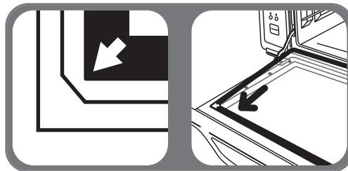
Setzen Sie die innere Scheibe (Markierung Innenseite der Tür) wieder ein. Achten Sie darauf, die Scheibe richtig zu positionieren: Die **runden Ecken müssen sich unten befinden** (Richtung Türgelenk). Führen Sie die oberen Ecken zuerst in die Aussparungen ein (siehe Pfeile). Befestigen Sie die Verbindungen wieder. Befestigen Sie die Schrauben wieder, ohne sie zu fest anzuziehen.
