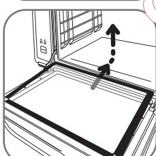
La vitre intérieure doit se soulever d'elle-même en partie inférieure pour une meilleure préhension. La déplacer vers l'intérieur du four pour la dégager de ses encoches de maintien.
