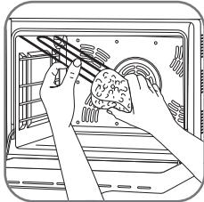
Der obere Heizwiderstand ist abklappbar, aber nicht herausnehmbar. Versuchen Sie den Heizwiderstand nicht gewaltsam zu entfernen.
