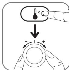
Drücken Sie die Taste **OK**. Stellen Sie die Temperatur mithilfe des Wählschalters ein, bis Sie die gewünschte Temperatur zwischen 80°C und 240°C erreicht haben.
