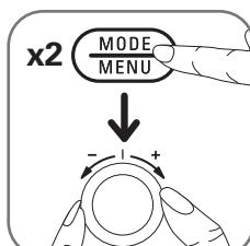
U beschikt over 2 mogelijkheden voor de programmering van uw oven: als u 2 keer achter elkaar drukt op de knop , gaat u van de handmatige functie over in de automatische functie en omgekeerd.
