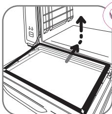
Het binnenste raam moet van onderen vanzelf omhoog gaan. Duw het raam in de ovenruimte om het uit de bevestigingsgaten te halen.
