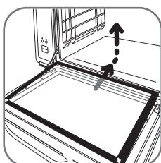
Die innere Scheibe sollte sich am unteren Ende selbst heben, damit sie sich besser greifen lässt. Schieben Sie sie in Richtung Ofeninneres, um sie aus den Halteaußsparungen zu entfernen.
