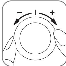
Als uw oven stroom heeft, geeft de digitale timer automatisch en knipperend "00:00" aan. Met behulp van de draaiknop (1e) draait u met de klok mee om de tijd vooruit te zetten of in de omgekeerde richting om de tijd terug te zetten totdat u het gewenste uur bereikt.
