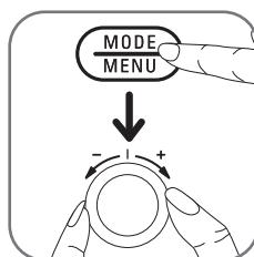
Om de bereidingsfunctie te kiezen, drukt u op de knop **MODE/MENU**. Selecteer de bereidingsfunctie door de draaiknop te draaien (1e).
