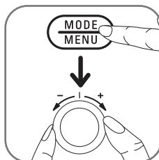
Sie können eine Zubereitungsweise auswählen, indem Sie auf die Taste **MODE/MENU** drücken. Wählen Sie die Zubereitungsdauer mithilfe des Drehknopfs (1e) aus.
