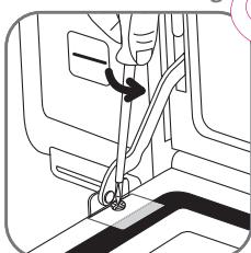
Öffnen Sie die Tür. Achten Sie darauf, dass sie auf der Arbeitsfläche aufliegt. Dazu können Sie Ihren Backofen gegebenenfalls um 90° drehen. Schrauben Sie die zwei Schrauben auf Höhe des Stützgestänges der Tür ab. Entnehmen Sie die zwei Verbindungen.
