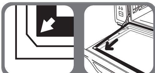
Plaats de binnenuitje terug op zijn plaats (markeringen aan de binnenkant van de ovendeur). Let erop om de ruit goed te plaatsen: de **afgeronde hoeken moeten onderaan zijn** (naar het deurscharnier gericht). Plaats de bovenste hoeken het eerst in de gaten (zie pijlen).
