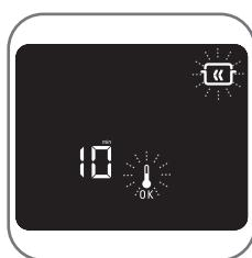
De aanwijzing gaat knipperen op het display tijdens het kookproces en wordt constant gedurende de automatische warmhoudfunctie. Het is mogelijk om de functie warmhoudfunctie zonder voorafgaand kookproces te gebruiken (bijvoorbeeld om borden op te warmen), druk in dit geval op de knop wanneer de oven op stand-by staat.
