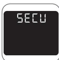
Deze functie is een aanvullende beveiling om te voorkomen dat kinderen de oven aanraken en/of bedienen. In de stand-by houdt de kinderbeveiliging de oven in stand-by zelfs wanneer de toetsen ingedrukt zijn of de draaiknop gedraaid is. Als de functie geactiveerd is tijdens de bereiding, kunt u geen instellingen wijzigen: om veiligheidsredenen behoudt alleen de toets **(STOP)** zijn functie om het kookproces te stoppen.
