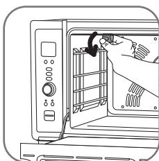
Pour remplacer l'ampoule :
