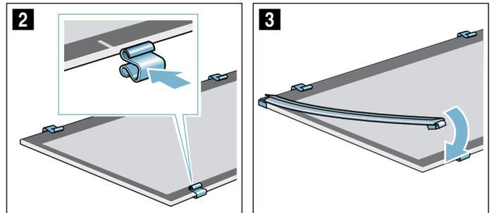
3. Placez la vitre intermédiaire avec les joints et les écarteurs. La flèche sur la vitre intermédiaire doit correspondre avec celle du cadre (figure 4).
