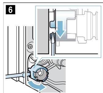
**Dépose et pose des vitres de la porte**
