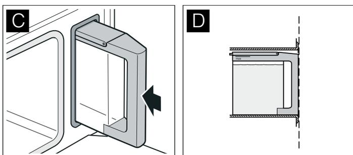
Le réservoir doit être au même niveau que son logement (fig. D).
