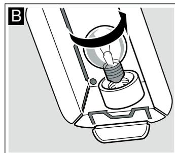
4. Remettre en place le cache en verre. Ce faisant, l'insérer d'un côté et l'appuyer fermement de l'autre côté. Le verre s'encliquete.
