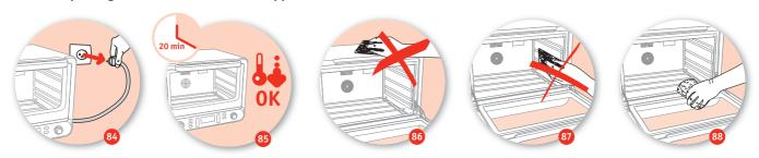
Avant tout entretien, nettoyage ou entreposage, débranchez et laissez refroidir l'appareil - fig.84-85.
