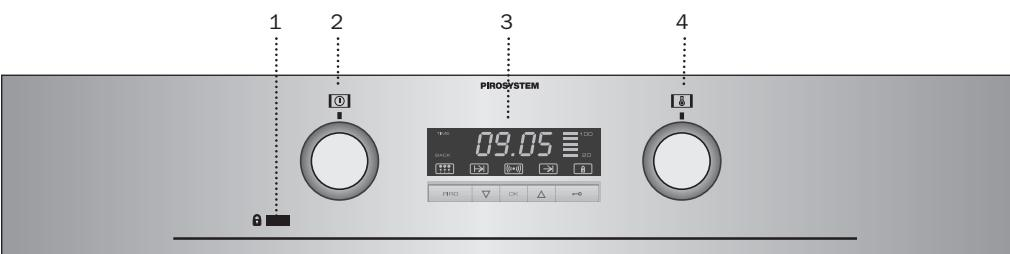
**1** Türblockierung. Wenn diese Lampe aufleuchtet, ist die Backofentür blockiert und kann nicht geöffnet werden.
