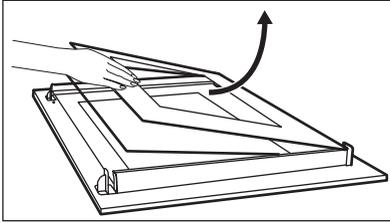
6. Saisissez les deux côtés du cache (B) situé sur l'arête supérieure de la porte et poussez-le vers l'intérieur pour permettre le déverrouillage du système de fermeture.
