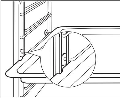
Le plat à rôtir et la grille métallique possèdent des rebords latéraux. Ces rebords, ainsi que la forme des guides d'insertion, empêchent les récipients de glisser.
