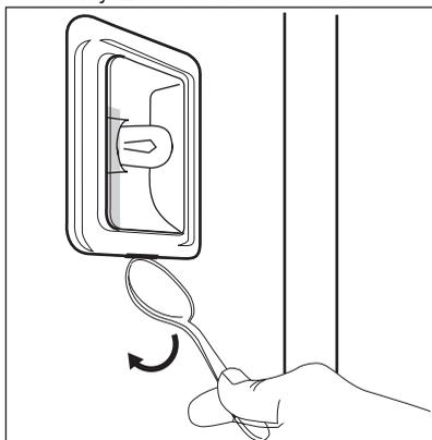
3. Remplacez l'ampoule par une ampoule adéquate résistant à une température de 300 °C.
