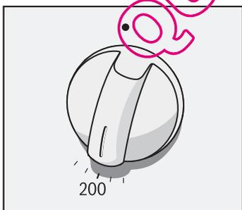
2. A l'aide du thermostat, régler la température ou la position gril.
