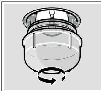
3. Remplacer l'ampoule par un modèle identique.
