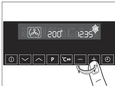
Les symboles de fin  $\rightarrow \text{I}$  et de durée  $\text{I} \rightarrow \text{I}$  s'allument. Le four s'allume automatiquement.
